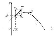
速度はベクトルであることに注意されたい。その上で曲線に沿って運動するのだから、速度の方向は曲線の接線上にある。したがって速度  $\overrightarrow{v}$  は、x 方向の成分  $v_x$  と y 方向の成分  $v_y$  に分解され、  $\overrightarrow{v}=(v_x,\,v_y)$  となっている。そのため、
